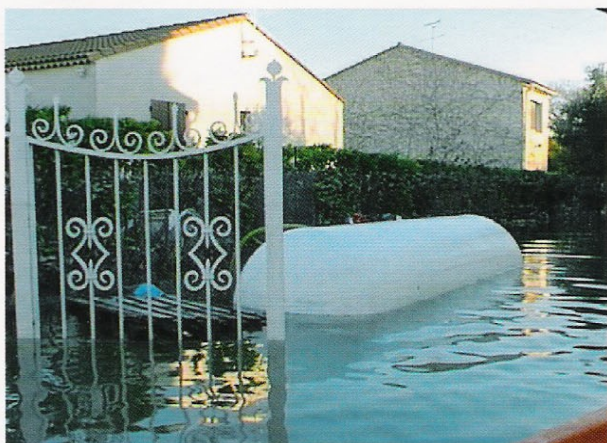
Cuve soulevée par l'eau.
